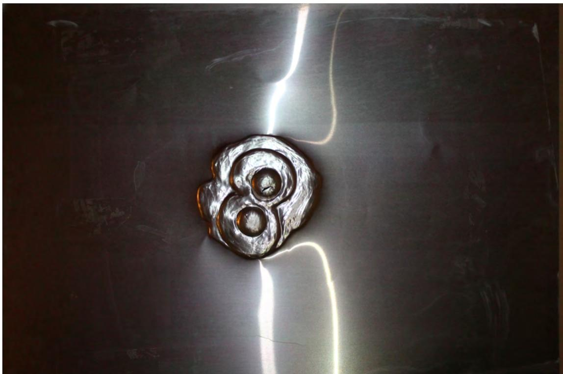
Essai d'embossage sur plaque offset pressée
